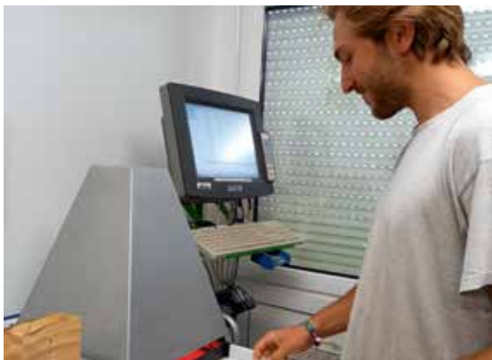
Bestimmen der Tausendkornmasse und des Hektolitergewichts von einer Weizenprobe mithilfe eines Bildanalysegeräts
