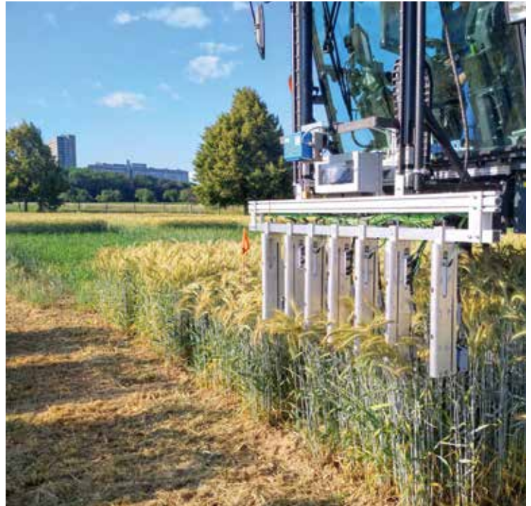
Einsatz des Lichtgitterkamms an der BreedVision-Plattform im Feld
