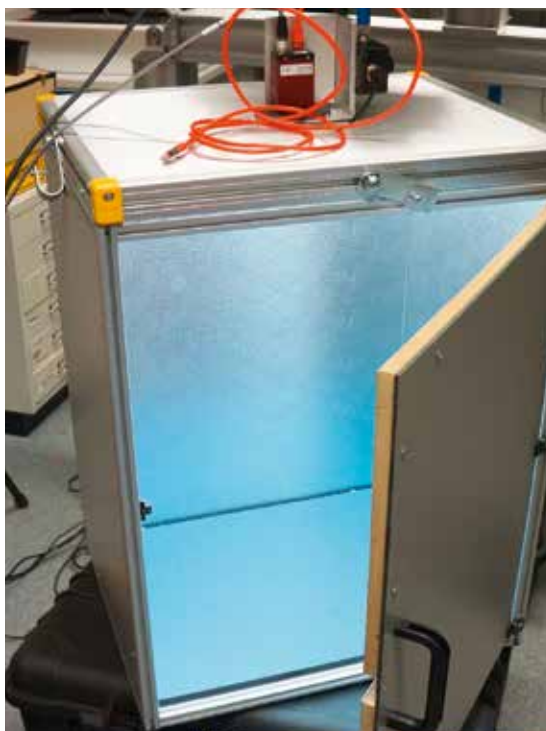
Bild-Aufnahmekammer zur Erfassung von Merkmalen an Buschbohnen
