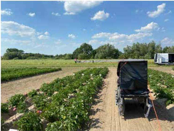
Bodengestütztes Trägersystem mit Kameraausleger zur Aufnahme von Spektraldaten unter Fremdlichteinfluss
