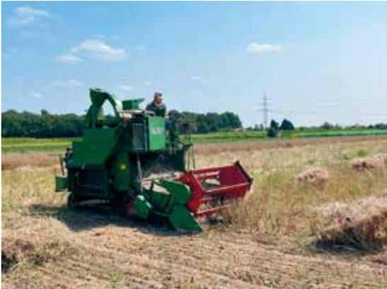
Erfassung der Stroherträge der Versuchspartellen mittels Haldrup-Grünmassevollernter
