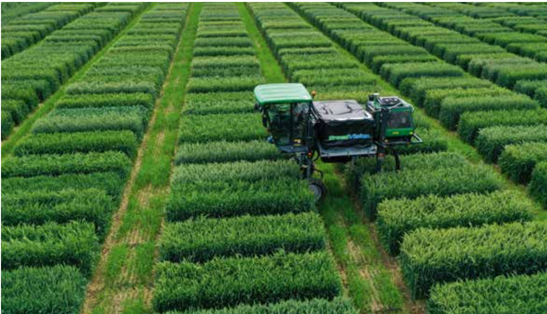
Die Feldphänotypisierungsplattform BreedVision bei einer Messfahrt im Feld
