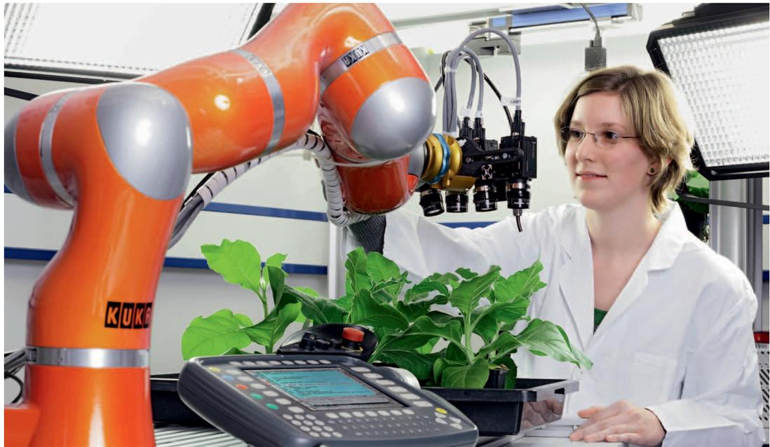
Industrieroboter zur Automatisierung der Analyse pflanzlicher Phänotypen
